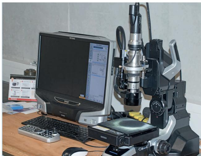
**3** Mit dem Digital-Mikroskop Keyence VHX-5000 erfassen die Forscher die auf den Filtrationsmembranen abgelagerten Partikel. Dabei wurden die Bilder gestitcht, das heißt, aus verschiedenen Einzelbildern zusammengesetzt
