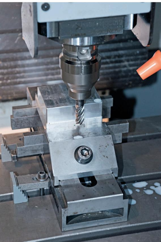
**1** Basis des Versuchsaufbaus im dreiachsigen Muga-Center R4530 mit Fräser Cut&Form von Emuge-Franken am KSF in Tuttlingen. Untersucht wurde hier der KSS-Einfluss beim Alu-Schlichten
