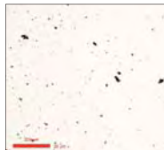
Kühlmittelprobe aus laufender Großserienproduktion. Partikelgrößen weit über den angestrebten Toleranzen und Oberflächengüten, trotz Bandfilteranlage!
