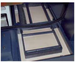
Filtration mit 1 µm: homogene, saubere und geruchlose Emulsion (Foto nach 60h Stillstand) Maschine frei von Ablagerungen
