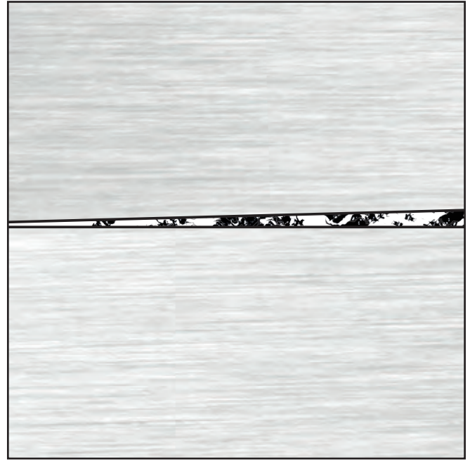
Nullpunkt-Spannsysteme: Abgelagerte Verschmutzungen beeinträchtigen die Präzision
